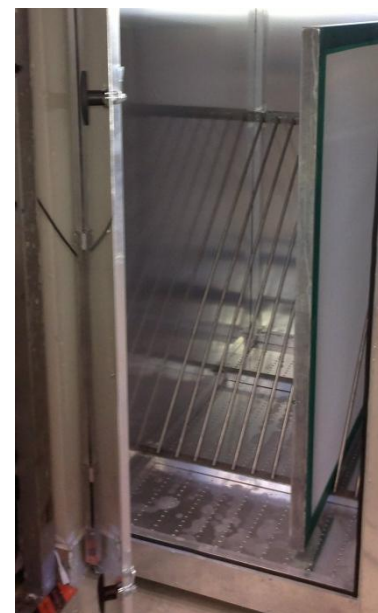
Konstrukcja kieszeniowa stabilizująca sita
