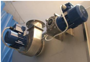
Wentylator wyciągowy i napęd posuwu dysz
